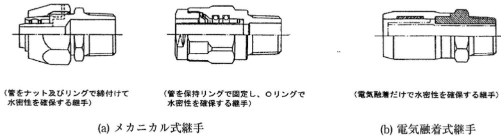
図3-17 架橋ポリエチレン管の継手例
