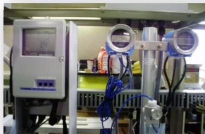
濁度計 PH計 電気伝導率計
