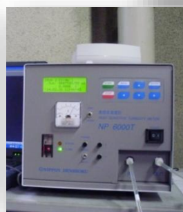
微粒子カウンター付 高感度濁度計
