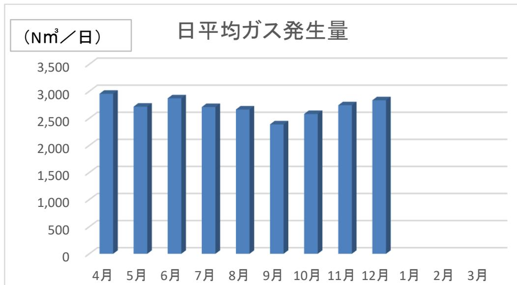
令和4年度大村浄水管理センター消化ガス発生量と消化ガス発電量
